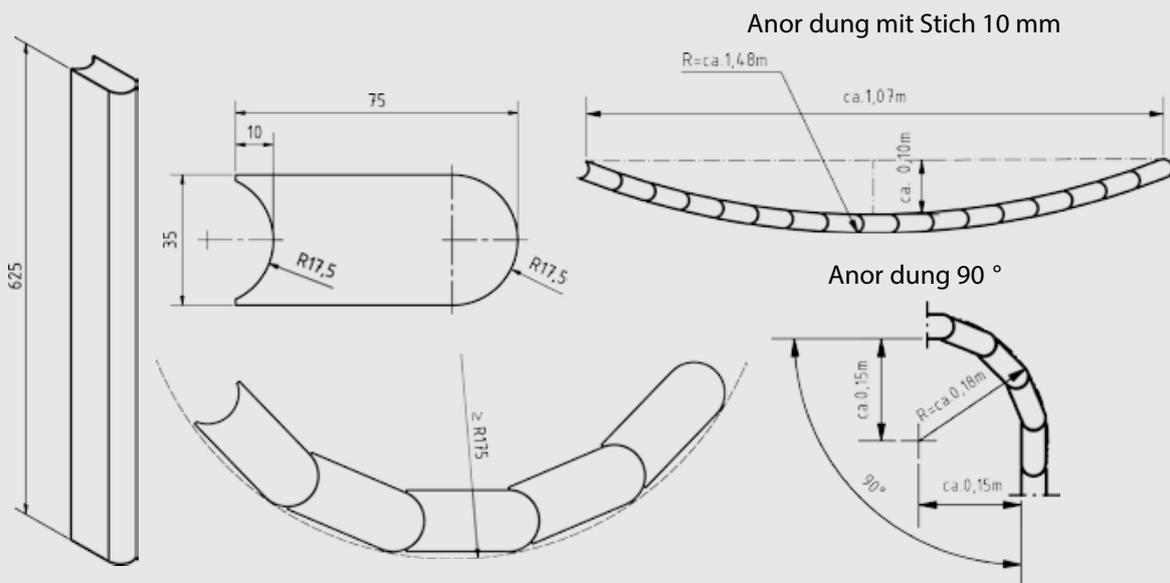
Auch Radien sind möglich. Hierfür steht das SILCAHEAT® 600C R75 Radius-Formteil zur Verfügung. Die präzisen Zuschnitte in der passenden Plattenbreite von 625 mm erleichtern die Formgebung auch bei unterschiedlichen Radien sowohl konvex wie konkav.
